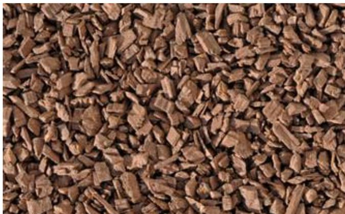
Die CW2000 Ausgleichsschüttung eignet sich für große Unebenheiten (10-200mm) und zur Überdeckung von Rohrleitungen. CW2000 ist die erste Ausgleichsschüttung, die ohne den Eintrag von Wasser oder anderen Bindemitteln stabil ist wie eine gebundene Schüttung.
