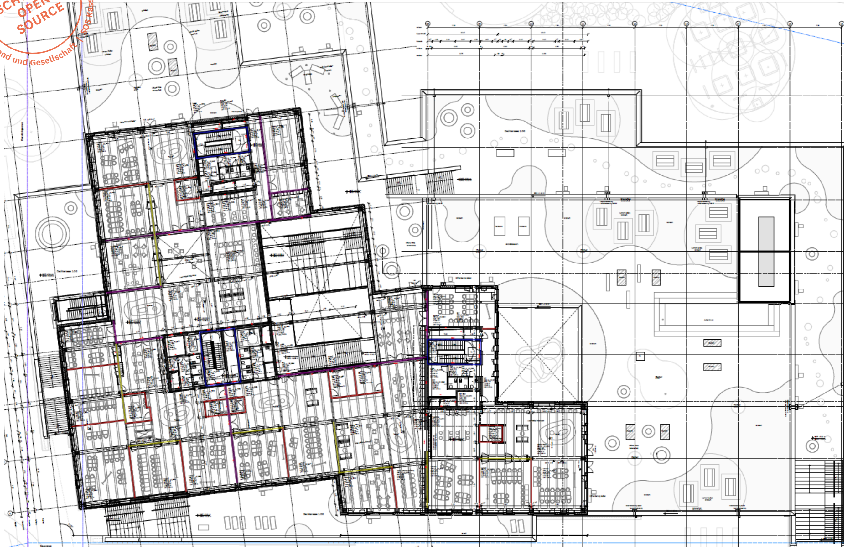
Grundriss 2. Obergeschoss mit Schallschutzanforderungen / U 4 /
