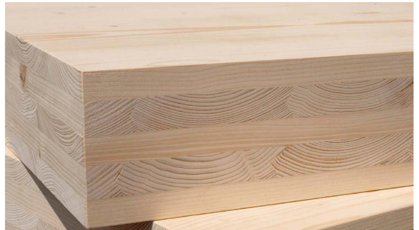
Brettsperrholz (BSP) für die Deckenfelder (3)
