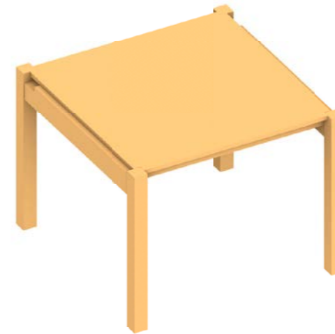
3 Rippendecke (b=2,50m) aus BSP-Platte und BSH-Rippen
