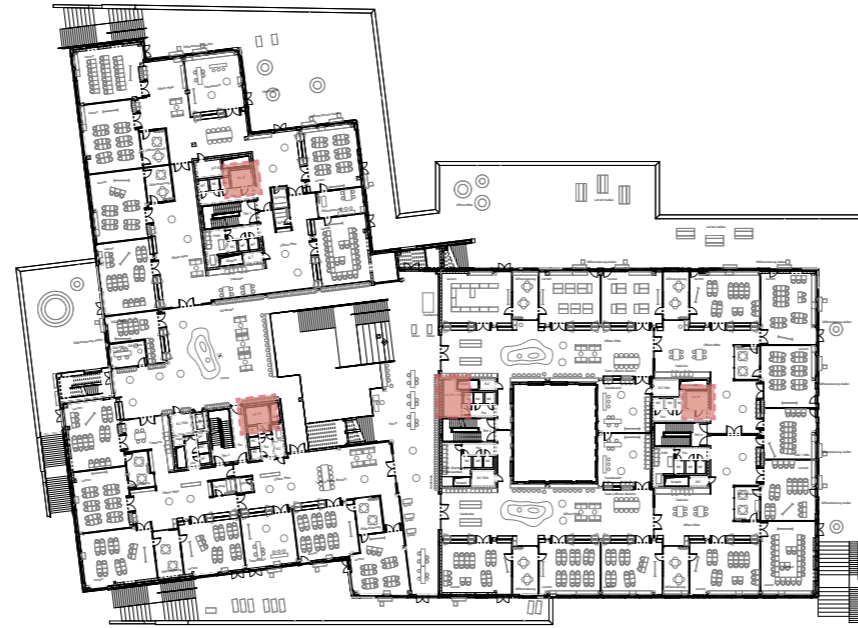
Barrierefreie Toiletten - 1. OG
