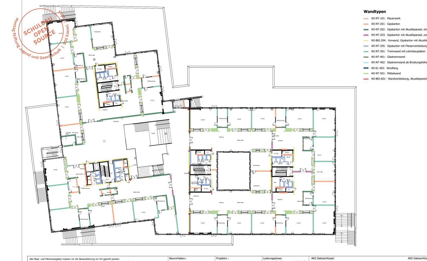
WI-NT-202: Gipskarton mit Akustikpaneel, einseitig WI-NT-203: Gipskarton mit Akustikpaneel, zweiseitig WI-BKI-204: Vorwand, Gipskarton mit Akustikpaneel WI-NT-205: Gipskarton mit Fliesenverkleidung WI-NT-301: Trennwand mit Lehmbauplatten
