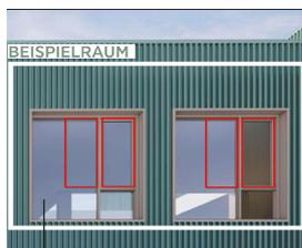
Fenstermodul: aktuelle Gesamtbreite und -höhe 2,6x3,1 m -> ca. 8 m<sup>2</sup>
