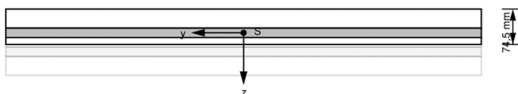
Abbildung 1-10: Abbrand und Restquerschnitt
