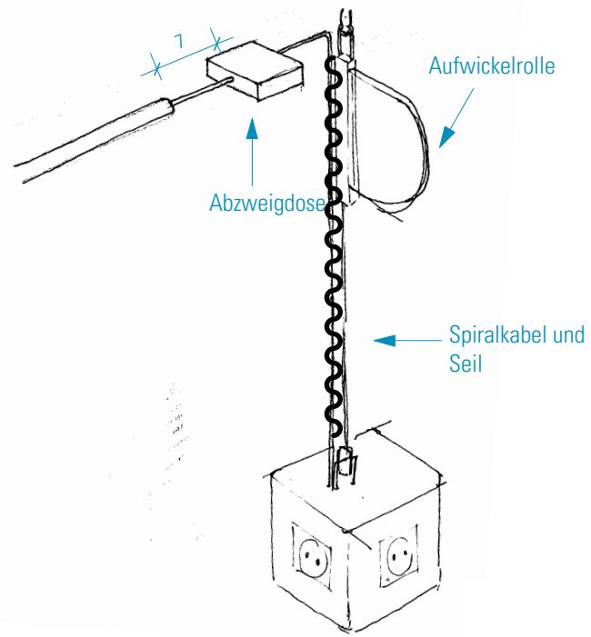
Befestigung des Steckdosenwürfels und aller dazugehörigen Komponenten gem. Bemusterung und Musterdecke und gem. DE 752; Lage gem. Deckenspiegel
