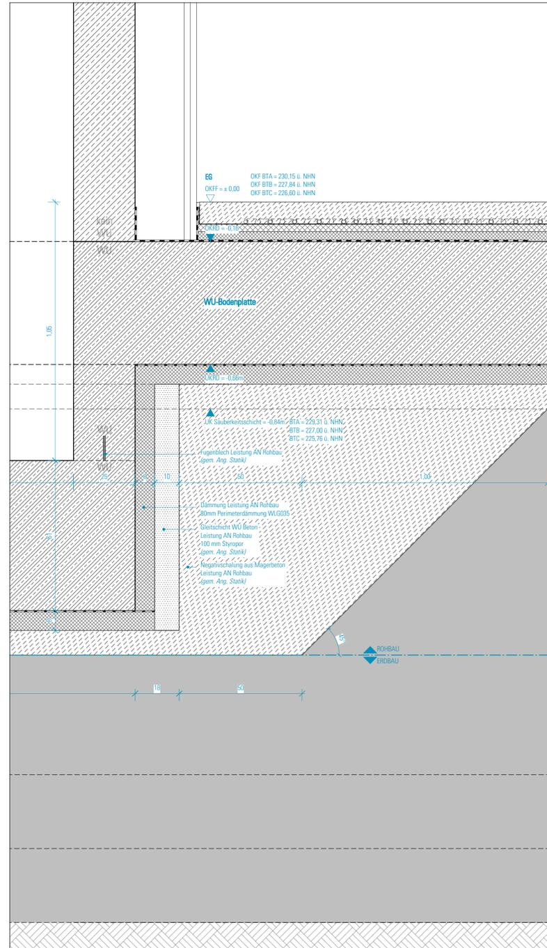
Regel-Querschnitt Aufzugsunterfahrt M 1:10
