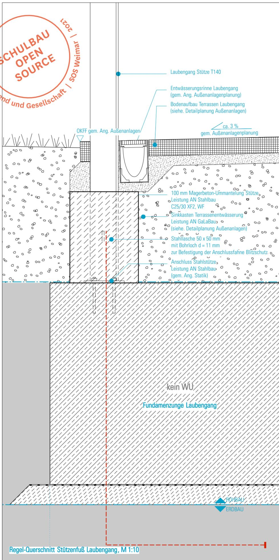
Regel-Querschnitt Stützenfuß Laubengang, M 1:10
