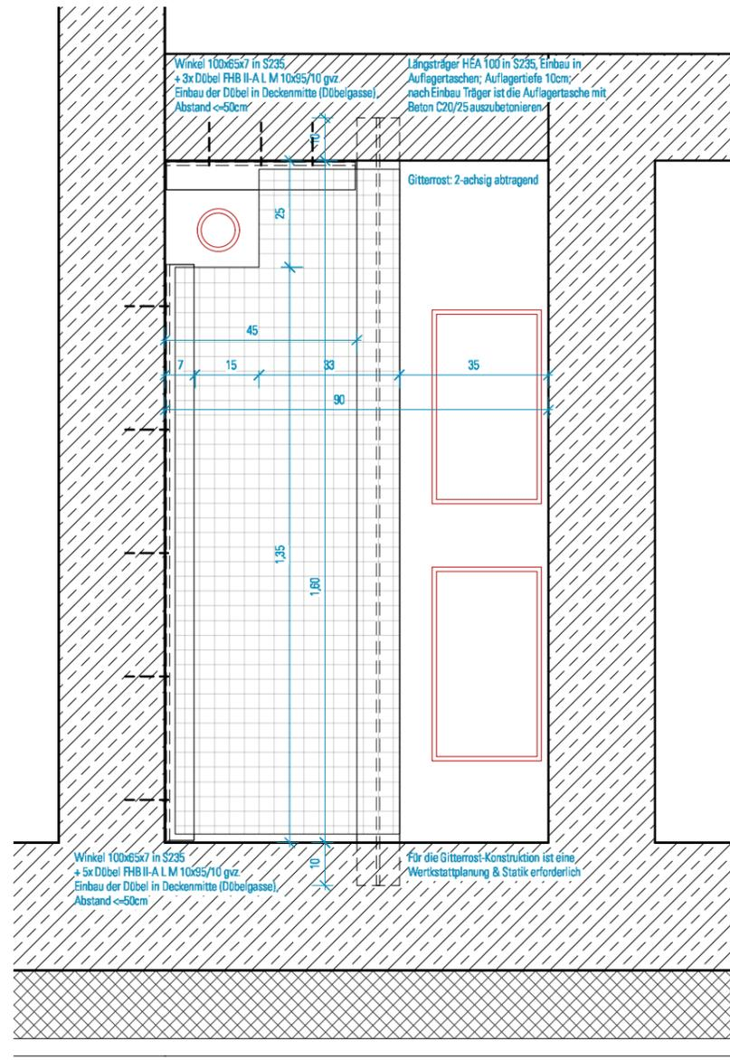
Regel-Grundriss HLS-Schacht I Schachtwischendecke, M 1:15
