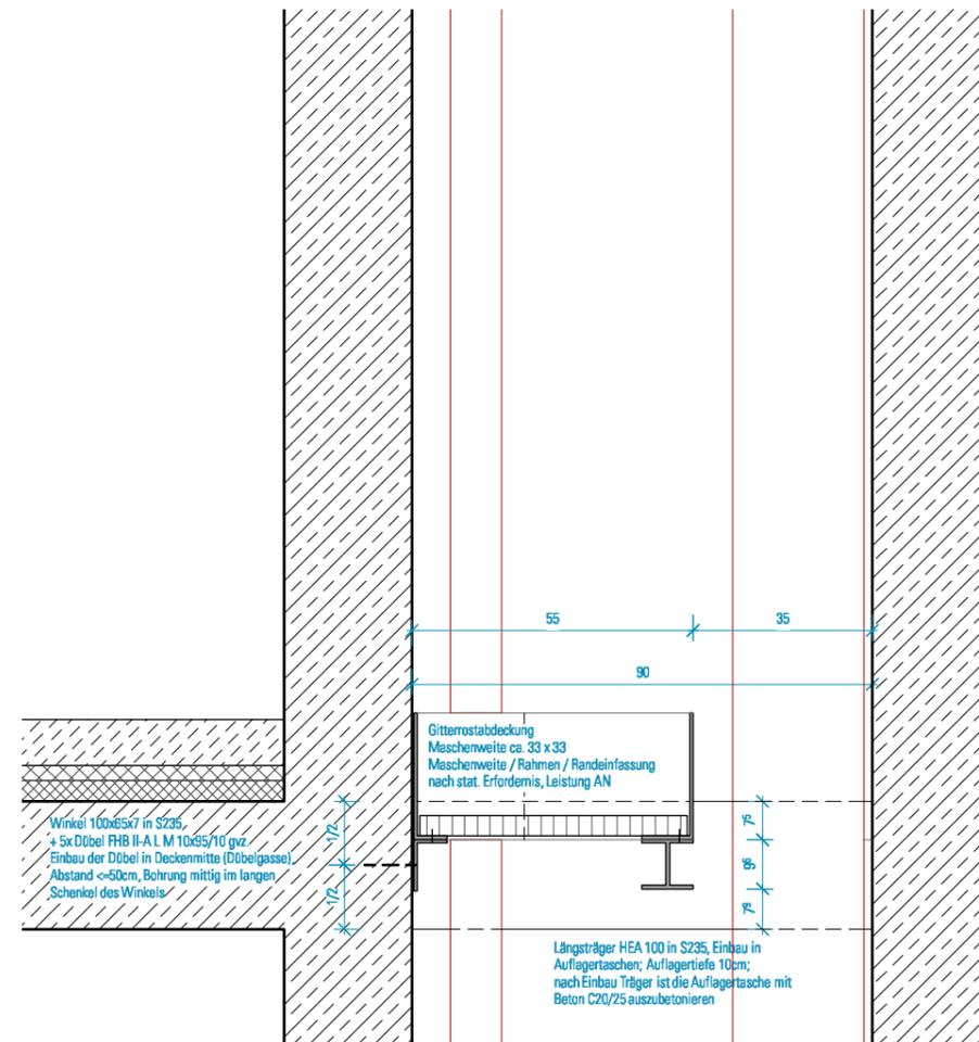
Regel-Schnitt HLS-Schacht I Schachtwischendecke, M 1:15
