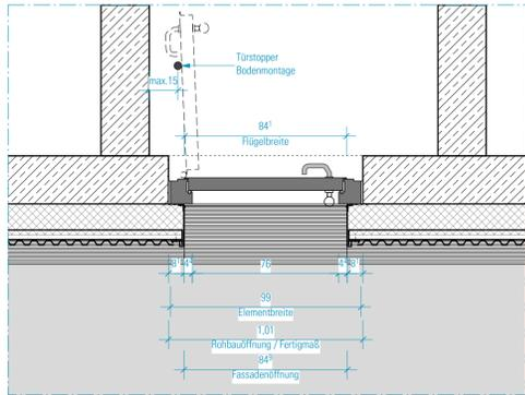
Stahl-Tür 1:20 Horizontalschnitt Erdgeschoss
