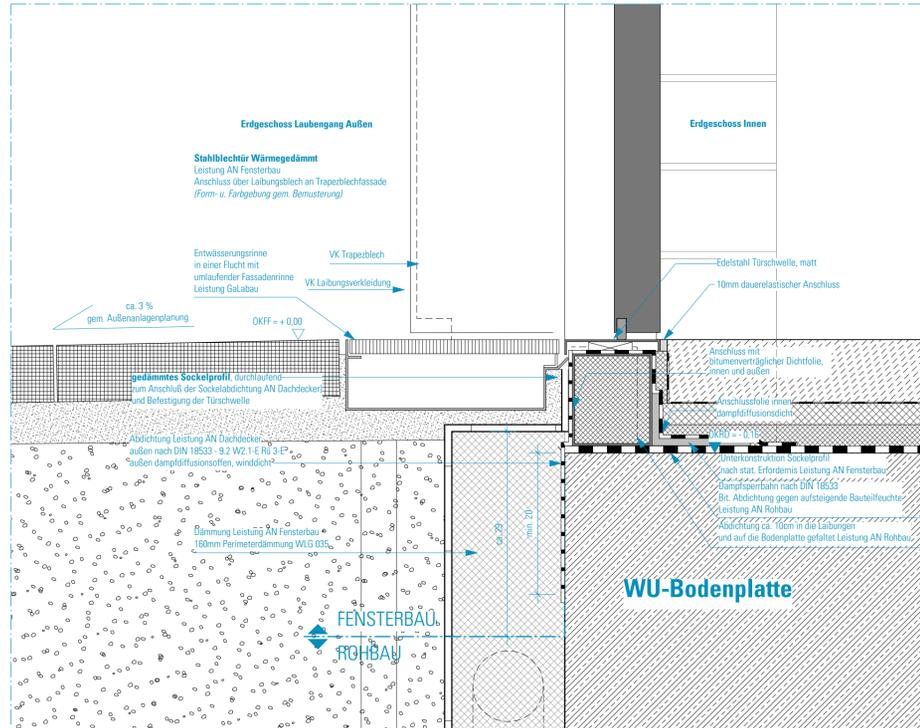
Stahl-Tür 1:5 unterer Anschluss Erdgeschoss
