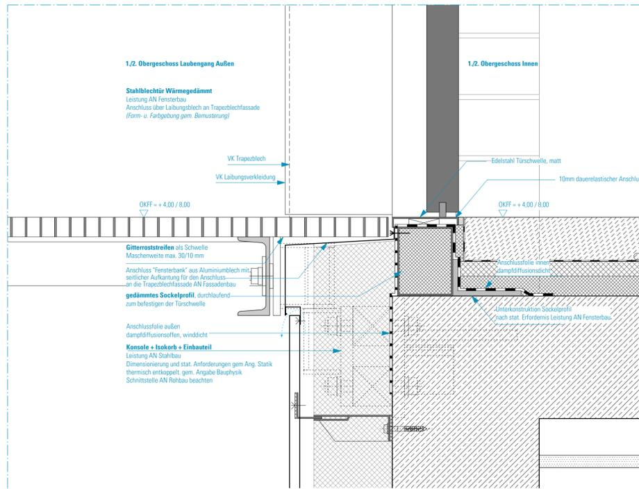
Stahl-Tür 1:5 unterer Anschluss Obergeschoss 1./2.
