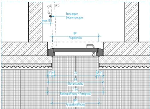
Stahl-Tür 1:20 Horizontalschnitt Erdgeschoss
