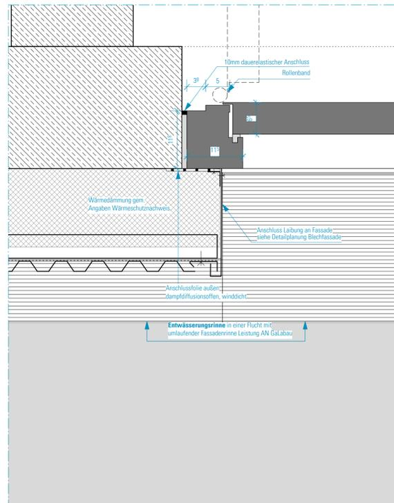
Stahl-Tür 1:5 Horizontalschnitt Erdgeschoss
