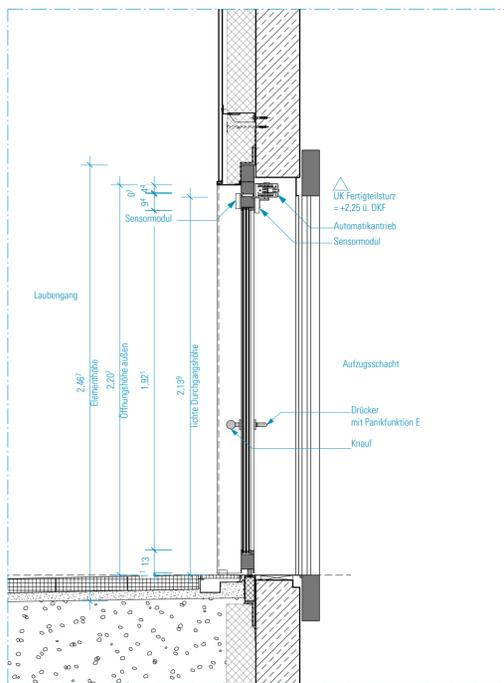
Vertikalschnitt 1:20 Erdgeschoss
