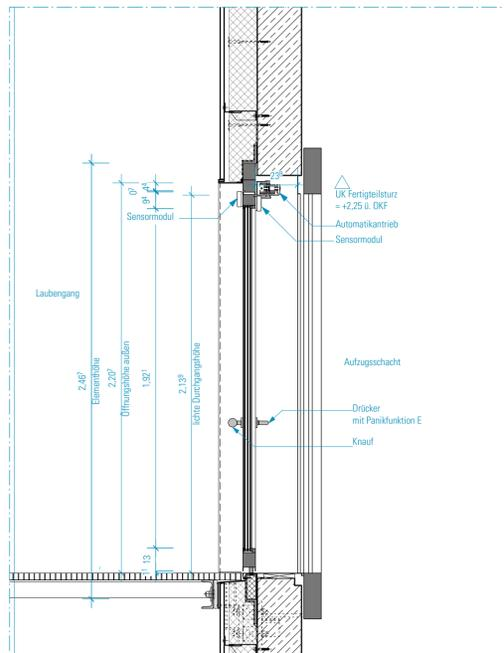
Vertikalschnitt 1:20 Obergeschoss
