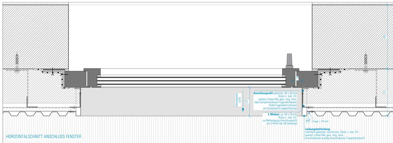
HORIZONTALSCHNITT ANSCHLUSS FENSTER
