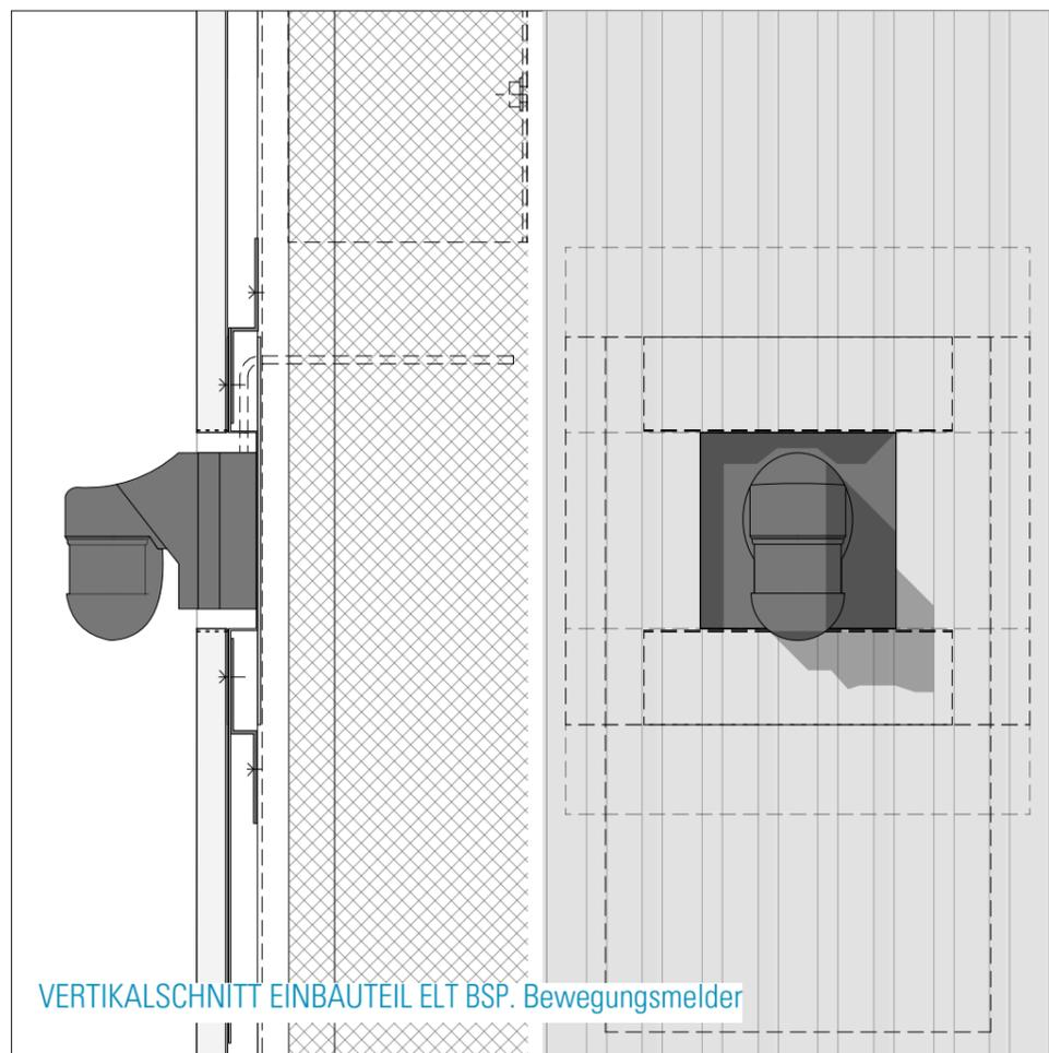
VERTIKALSCHNITT EINBAUTEIL ELT BSP. Bewegungsmelder
