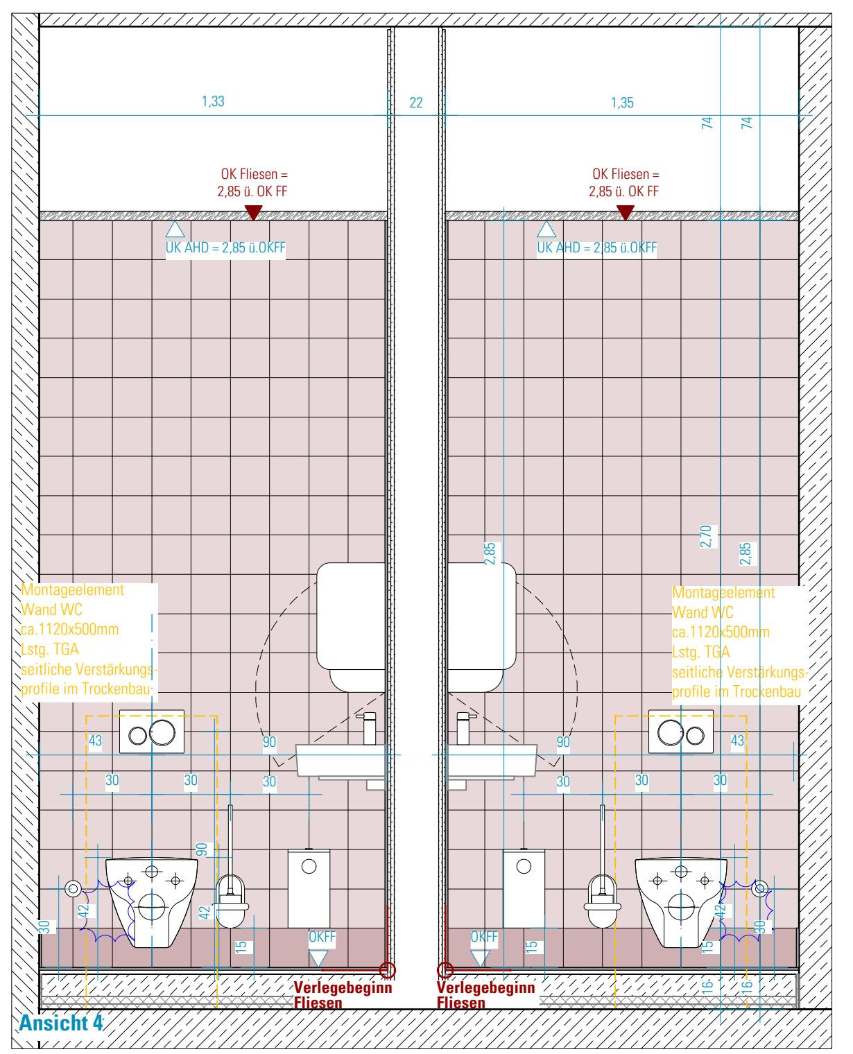
**HINWEISE:** Alle Maße sind von den Ausführenden verantwortlich zu prüfen. Abweichungen und Unstimmigkeiten jeglicher Art sind vor der Ausführung der Bauleitung mitzuteilen. Der Plan gilt nur in Zusammenhang mit der Statik und den entsprechenden Schalplänen. Sämtliche Höhenangaben beziehen sich auf ± 0,00 bzw. m ü.NN.
